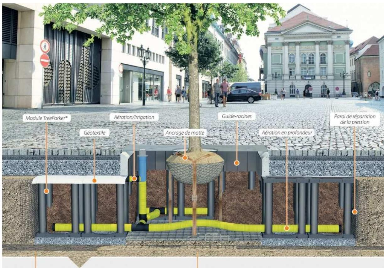
Nous n'avons pas trouvé d'exemple de système Tree Parker sur une dalle étanche, les caissons étant généralement posés dans des fosses en pleine terre, isolées par un géotextile perméable tant à l'eau qu'aux racines. Le cas de fosses étanches demande une gestion des eaux stagnantes couplée avec les programmes d'alimentation en eau et nutriments par une intelligence artificielle disposant de capteurs multiples.
